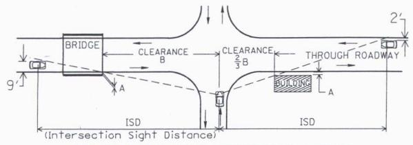
DIAGRAM A - HORIZONTAL COMPONENTS (Sec.201.32)
